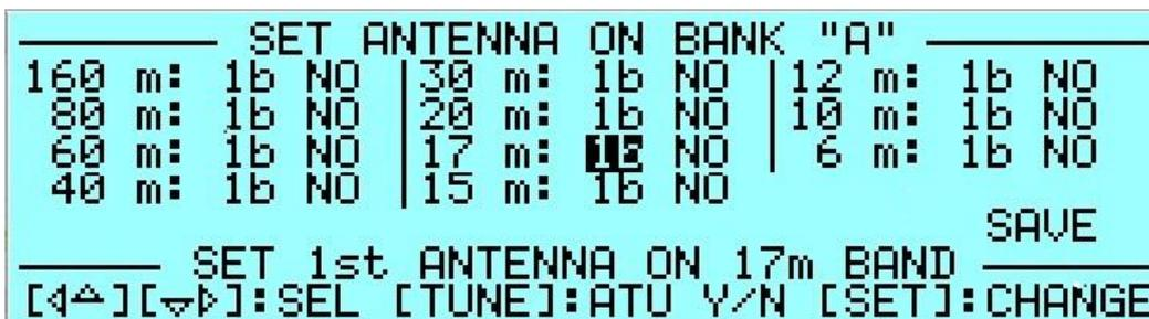
La programmazione permette di inserire fino a due antenne per la stessa banda. Ciascuna delle due antenne può essere selezionata, tramite il tasto [ANT], durante l'uso sia in modalità "STANDBY" che "OPERATE" ma non durante la trasmissione,
