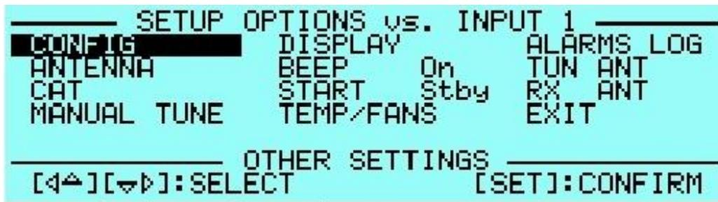
b) ANTENNA: Associa a ciascuna banda la relativa antenna, selezionando il connettore (ANT 1, ANT 2, ANT 3, ANT 4) a cui l'antenna è collegata. Se non si dispone di antenna per una certa banda, inserire "NO".
